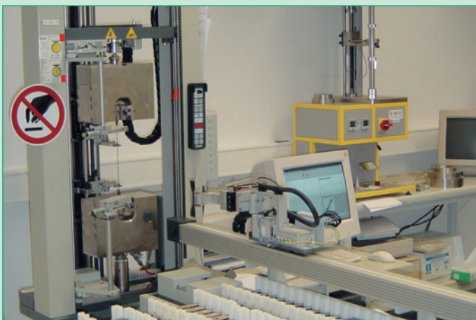
Fig. 7: Tensile test on Carbofol® geomembranes (ISO 527)
